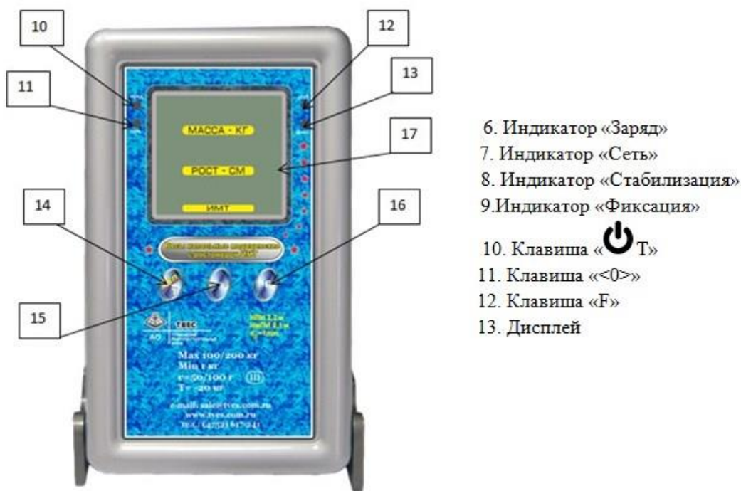
Рисунок 7 – Панель управления медицинских весов с ростомером моделей ИМТ–С, ИМТ–С–В
