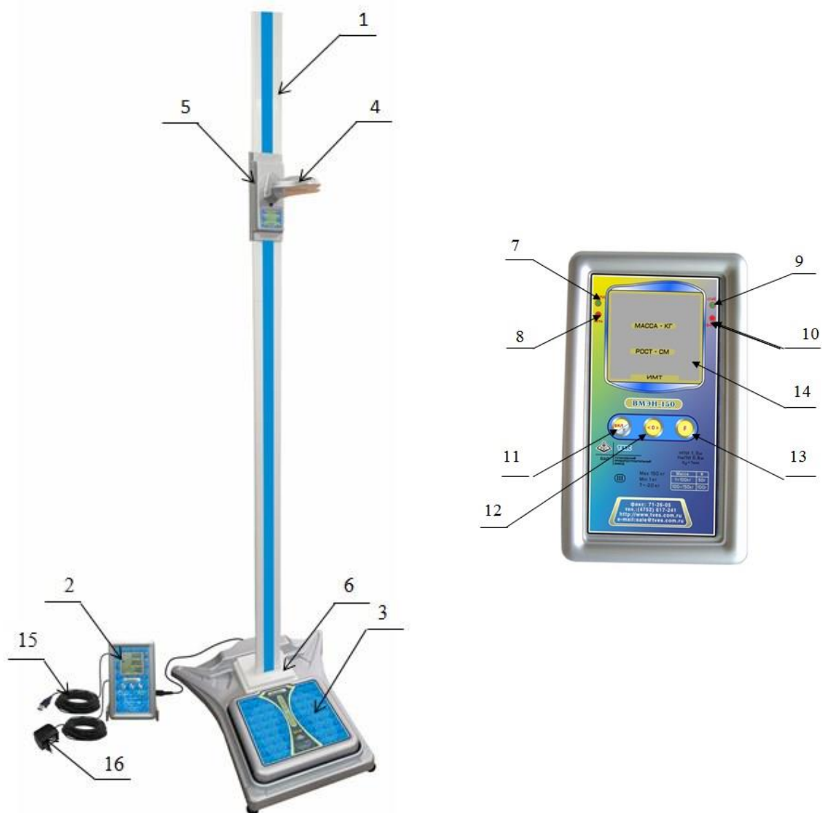
Рисунок 1 – Общий вид и панель управления весов моделей ВМЭН–150, ВМЭН–200
