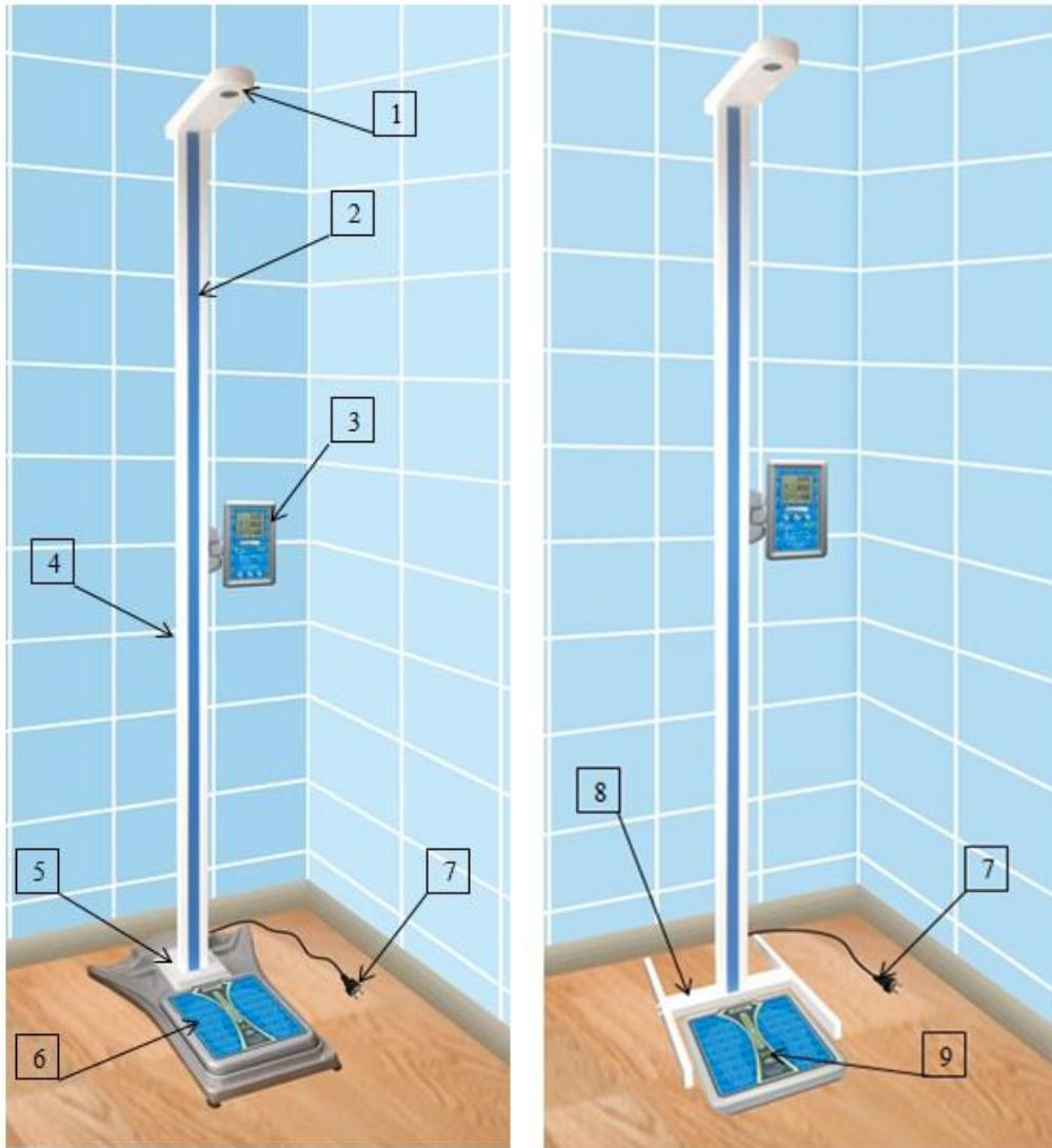
Рисунок 3 – Общий вид медицинских весов с ростомером моделей ИМТ–П, ИМТ–П–Н
